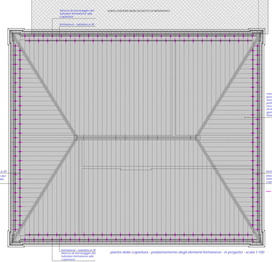
pianta della copertura - posizionamento degli elementi fermanee - in progetto - scala 1:100
