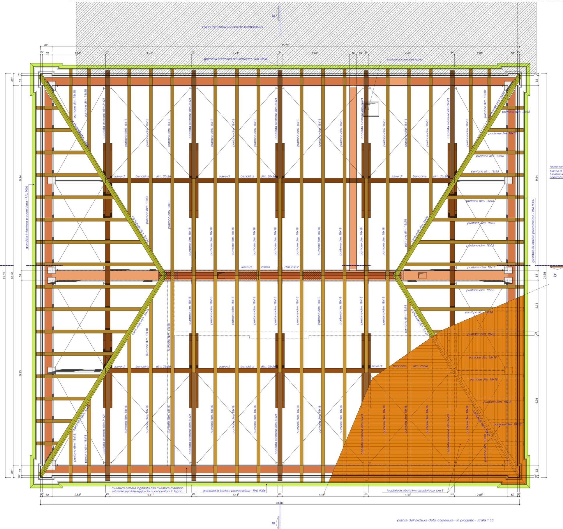
pianta dell'orditura della copertura - in progetto - scala 1:50
